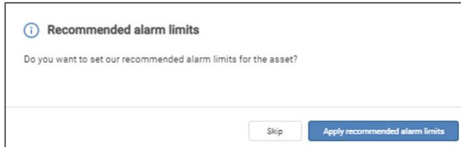
Este cuadro ofrece a los usuarios la opción de que el software establezca los límites de alarma automáticamente basándose en información específica de la instalación. La capacidad de tener información generada automáticamente es un ahorro de tiempo. Establece umbrales para las mediciones de vibración capturadas, incluyendo la velocidad global y las tendencias (bandas de velocidad y bandas de aceleración).
