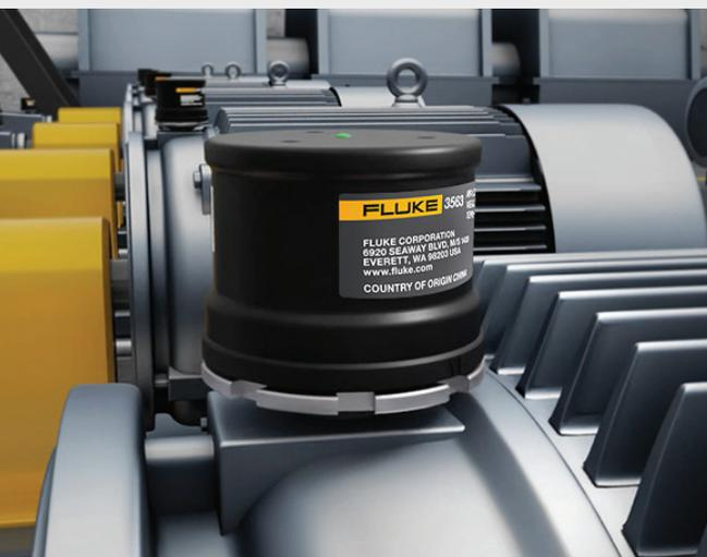
Der Fluke 3563 ist ein kabelloser Sensor zur Vorauswahl und Analyse von Schwingungsdaten an einer Reihe verschiedener Maschinentypen. In ihm wird ein piezoelektrischer Hochfrequenz-Sensor mit zwei MEMS-Sensoren und einer entsprechenden Software gekoppelt, damit Instandhaltungsteams regelmäßig Asset-Schwingungsdaten nachführen und analysieren können.
