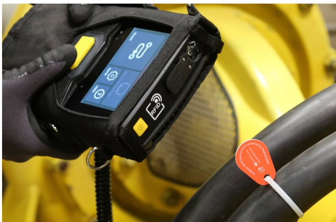
De RFID-leesmodule detecteert de codering van de transponder contactloos.
