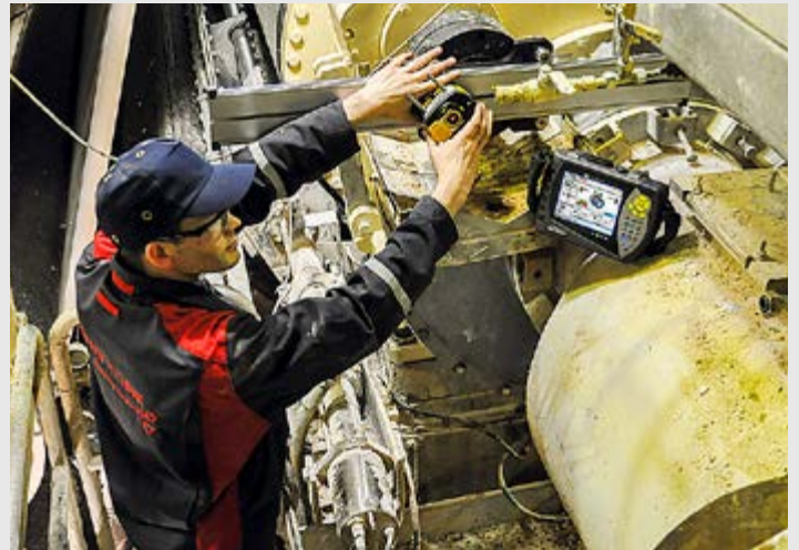
Ansicht beim Ausrichten mit ROTALIGN® Ultra iS und Kardanschwert
