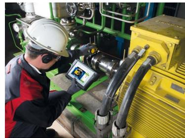
Adecuada para medir los ejes rotativos de los ejes acoplados de diversos tamaños y medidas
