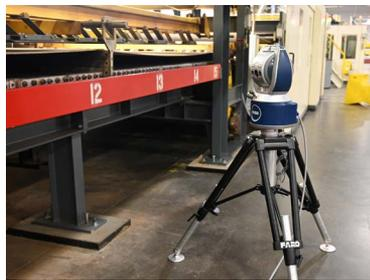
Adecuada para la alineación geométrica industrial compleja de diversos elementos de la maquinaria
