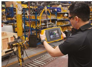
Adecuada para detectar fugas en las tuberías de aire o gas y en los sistemas de vacío
