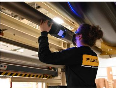
Adecuada para medir la desalineación de los rodillos, que puede provocar falta de eficacia y calidad
