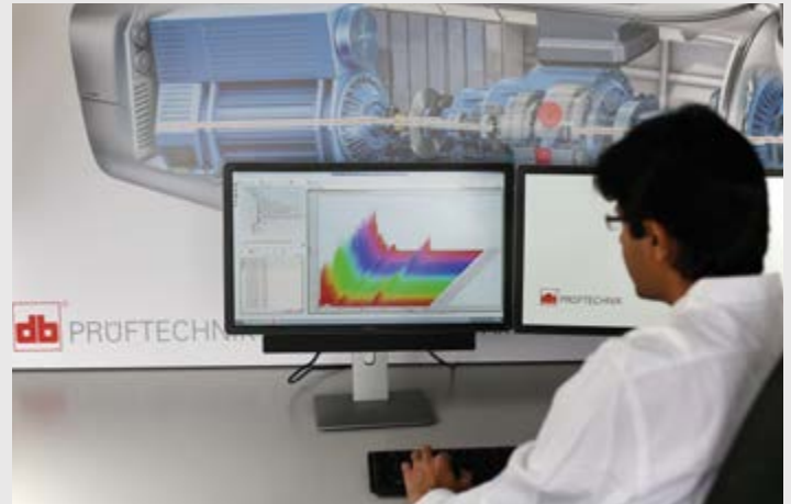
Analyse von Spektren mit OMNITREND® Center zur Fehlererkennung und -diagnose
