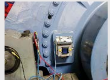
Anordnung zur online-Erfassung von thermischen Verformungen von Hauptlager und Hauptgetriebe zueinander
