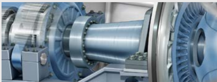
Spannsitze müssen korrekt zueinander stehen, bevor sie verbunden werden
