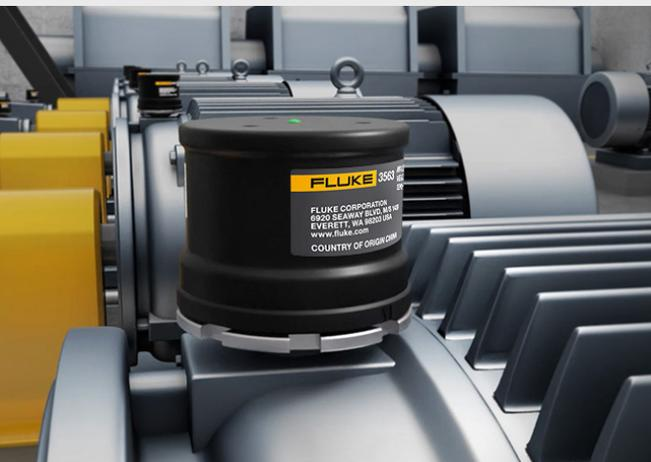
Le Fluke 3563 est un capteur de vibrations sans fil permettant de filtrer et d'analyser les données vibratoires sur une gamme de types de machines. Il combine un capteur piézoélectrique haute fréquence et deux capteurs MEMS avec un logiciel, permettant aux équipes de maintenance de suivre et d'analyser régulièrement les données relatives aux vibrations des machines.
