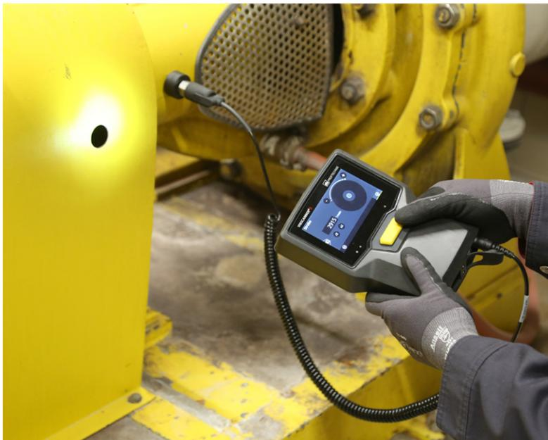
Orientez le stroboscope sur les composants rotatifs.
