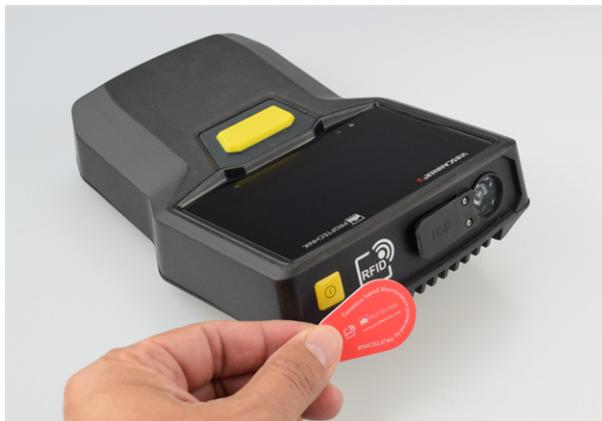
Identification des points de mesure avec la technologie RFID (ISO 14443a et ISO 15693).
