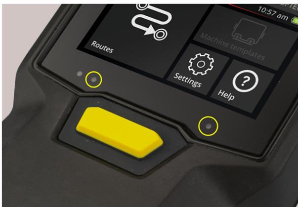
Les deux orifices d'entrée du capteur de luminosité ambiante.
