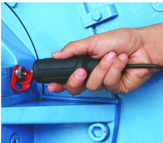
Raccord du capteur VIBCODE au point de mesure VIBCODE.
