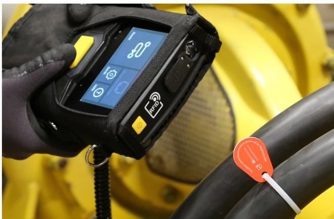
Le module de lecture RFID relève le codage de la radio-étiquette sans contact.
