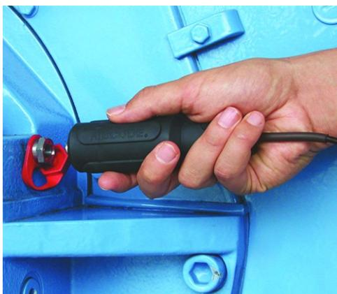
Collegare il sensore VIBCODE al punto di misurazione VIBCODE.
