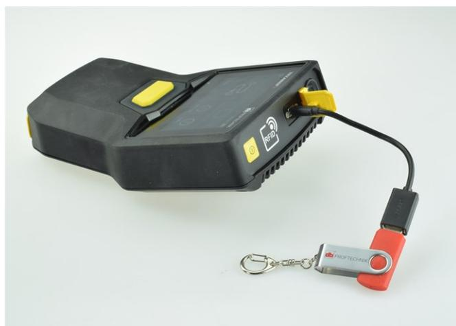
Supporto di memoria USB con adattatore di collegamento collegato a VIBSCANNER 2.
