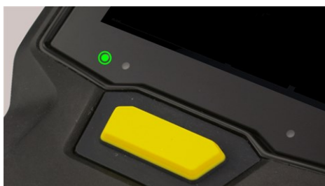
Wskaźnik poziomu naładowania LED w trybie uśpienia.
