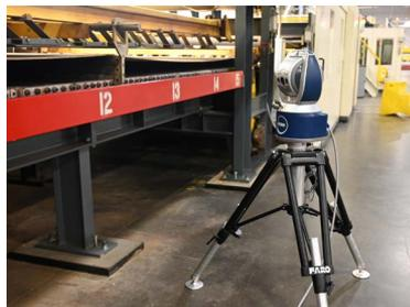
Für die komplexe geometrische Ausrichtung verschiedener Maschinenelemente im Industriebereich
