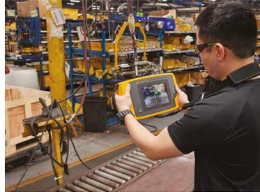
Für die Lecksuche in Luft- oder Gasleitungen und Vakuumanlagen
