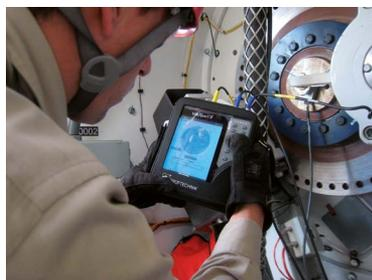
Für das Auswuchten von rotierenden Maschinen
