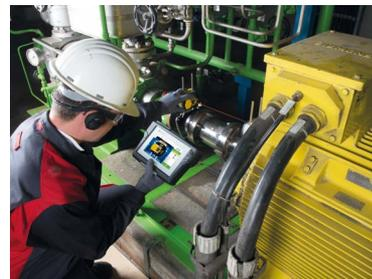
Für die Messung von Rotationsachsen gekuppelter Wellen in verschiedenen Größen und Längen
