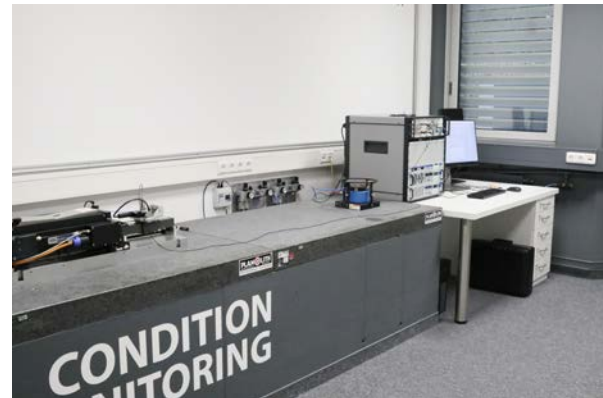
Die beiden Shaker sitzen auf über sieben Tonnen Beton und Granit, um ca. 50 Gramm leichte Condition Monitoring Schwingungssensoren zu kalibrieren. Im Hintergrund: hohe Rechenleistung zur maximal schnellen Analyse.
