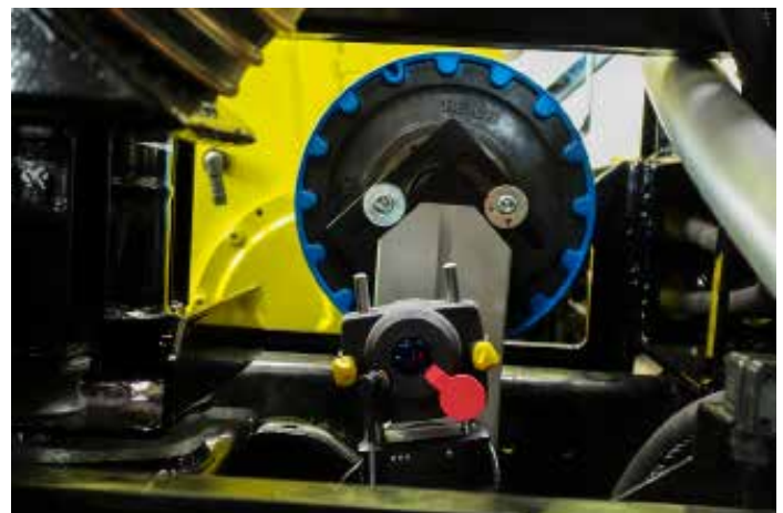
Ricevitore sulla pompa ad alta pressione. La testa del sensore è montata su un dispositivo di rotazione, si rileva soltanto l'errore angolare.
