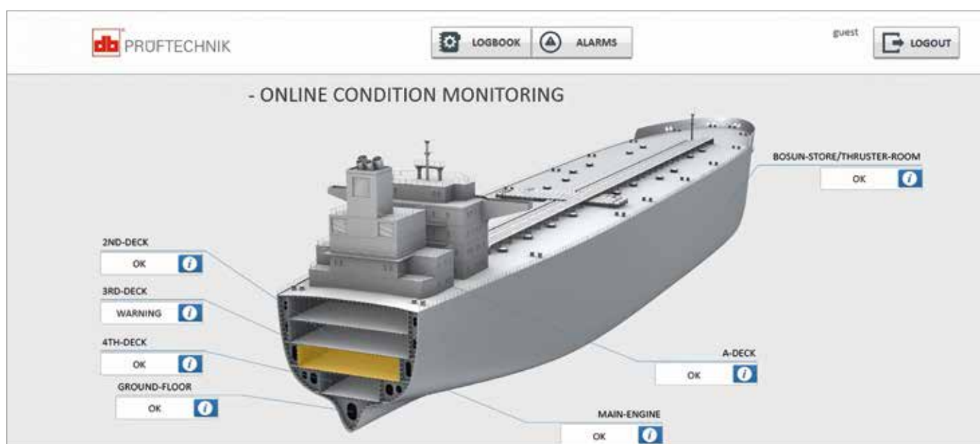
Fig. 1 : Tableau de bord en ligne de l'état des machines sur le bateau
