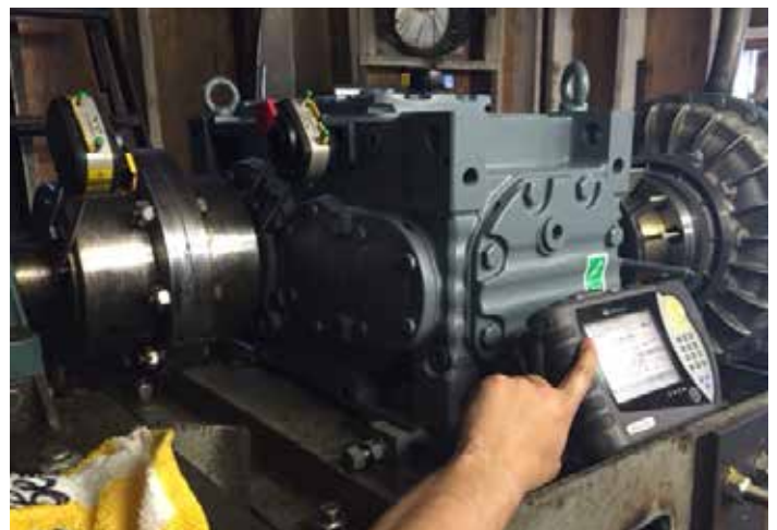
Abb. 2 Analyse der Ausrichtung mit ROTALIGN® Ultra iS
