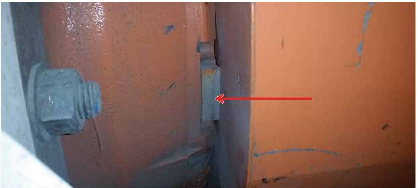
Figure 11 : Bloc de montage de l'accéléromètre – extrémité motrice
