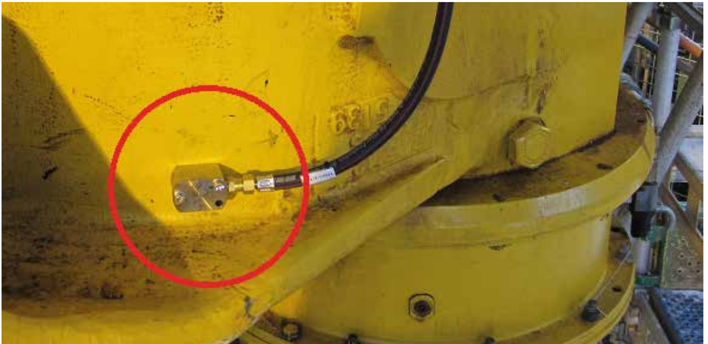
Abbildung 10: Mini-Beschleunigungssensor, Gehäuse und Hydraulikschlauch-Kabelschutz
