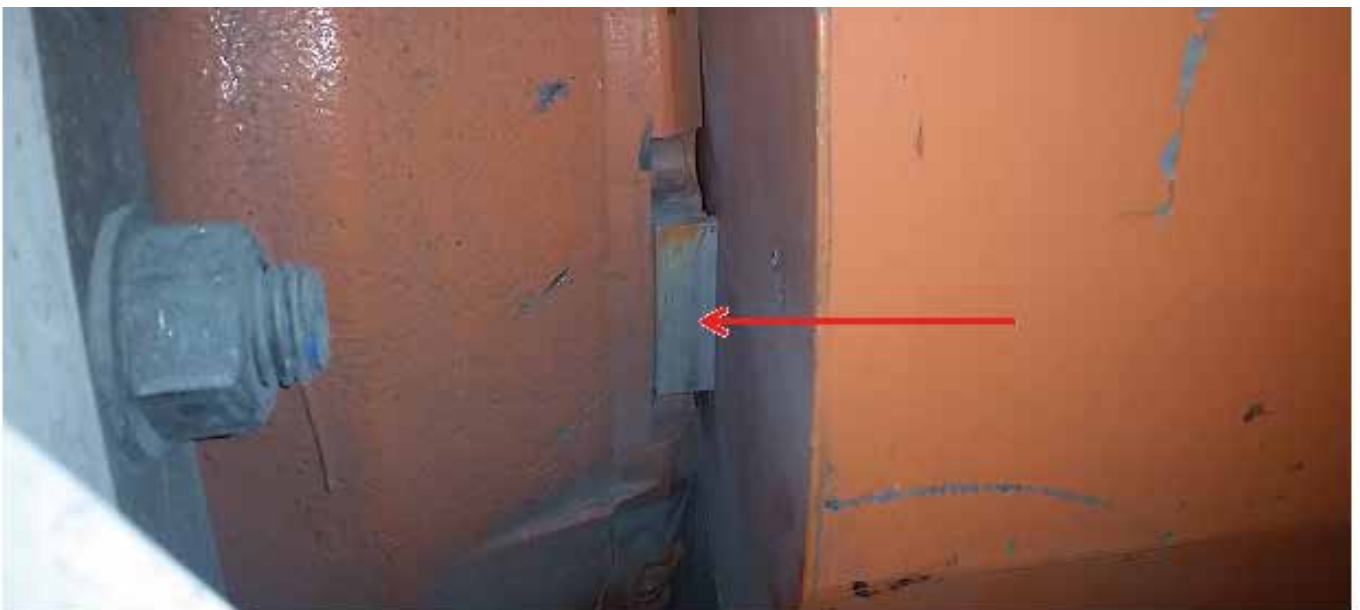
Figura 11: Bloque de montaje del acelerómetro – motor con cojinete del lado del acoplamiento
