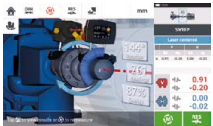
Alle ROTALIGN® und OPTALIGN® Ausrichtgeräte von PRÜFTECHNIK bieten den sogenannten „SWEEP Modus“ an, um Wellen zielgerichtet und exakt auszurichten. Dieser Messmodus wird auch für Turbokupplungen verwendet.
