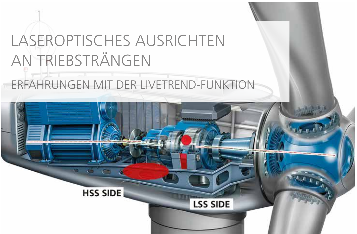
Bild 1: Ansicht eines typischen Triebstranges mit veranschaulichten Ausrichtabweichungen
