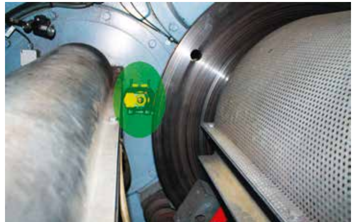
Bild 3 (links) und 3a (rechts) : Ansichten der montierten Lasersensoren, um Verlagerungen, Bewegungen und Verkippen der Triebstrangkomponenten zueinander zu erfassen
