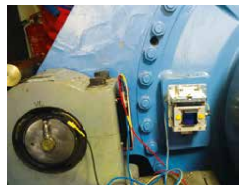
Imagen 6a (arriba) y 6b (abajo): montaje de la unidad láser y receptora —a la izquierda junto al cojinete principal y a la derecha junto a la caja de engranajes— para calcular las especificaciones de alineación
