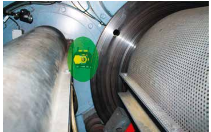
Imagen 3 (izquierda) y 3a (derecha): vistas de los sensores láser montados para registrar desplazamientos, movimientos y desviaciones de los componentes del sistema de transmisión, unos con respecto a los otros
