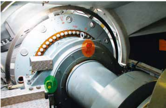
Imagen 3 (izquierda) y 3a (derecha): vistas de los sensores láser montados para registrar desplazamientos, movimientos y desviaciones de los componentes del sistema de transmisión, unos con respecto a los otros
