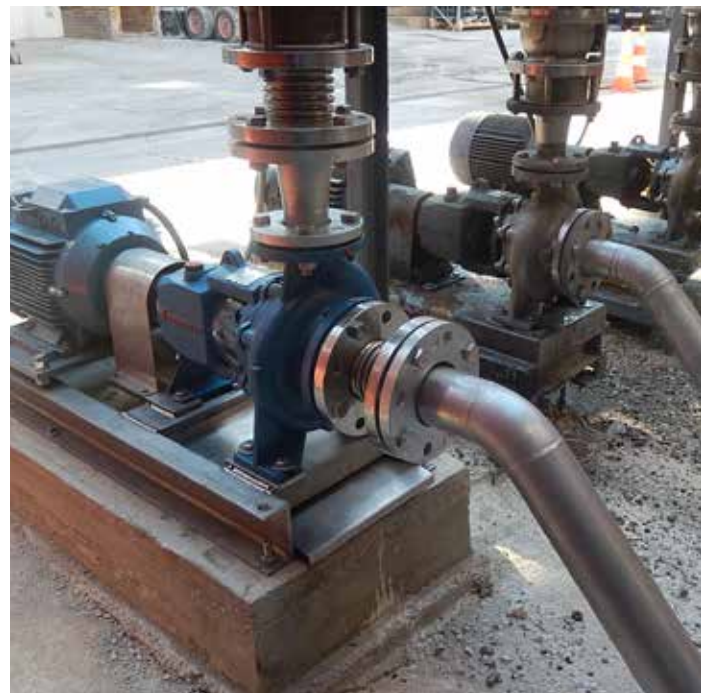
Neue Motorauflage mit Einstellschrauben in der Produktionsstätte Montmeló
