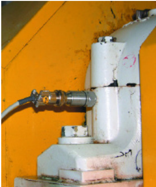
VIBROTECTOR montiert an einem Lagergehäuse
