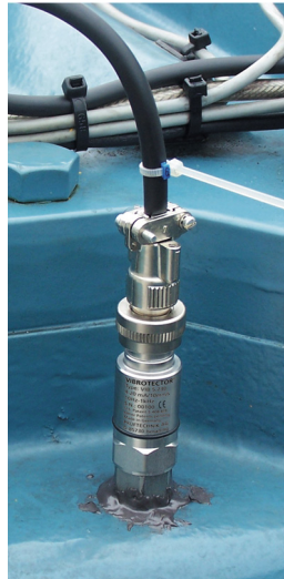
VIBROTECTOR montiert mit Klebeadapter
