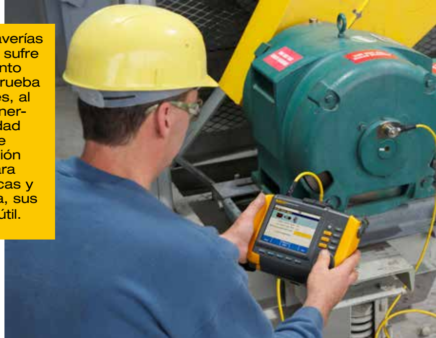
El analizador de vibraciones 810 supervisa los motores operativos.
