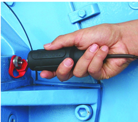
VIBCODE-Sensor an VIBCODE-Messstelle anschließen.
