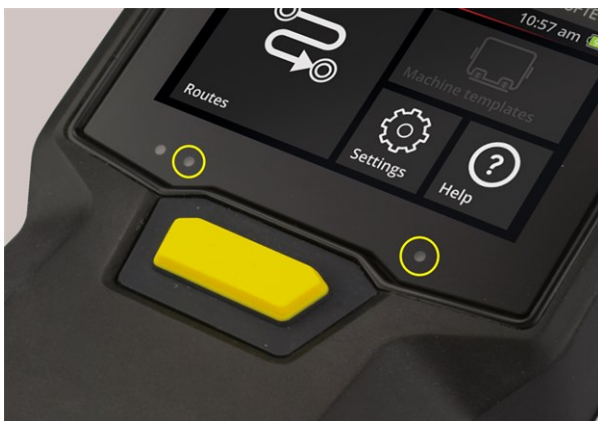
Zwei Eintrittsöffnungen für Umgebungslicht-Sensor.
