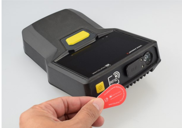
Messstellen identifizieren mit RFID-Technologie (ISO 14443a und ISO 15693).
