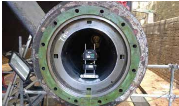
ROALIGN®-Sensor im Achterstevrohr positioniert
