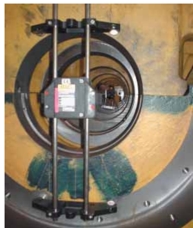
Abb.3: Der magnetisch befestigte Laser-Sender.
