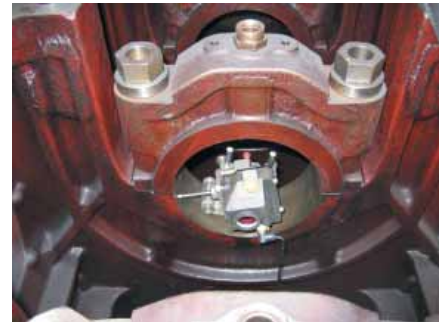
Abb.2: Der in der Bohrung drehbare Laser-Sensor.
