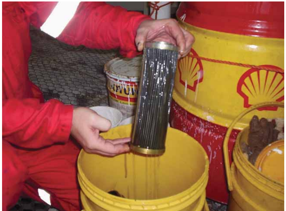
Abb.1: Zustandsanalyse am ausgebauten Ölfilter
